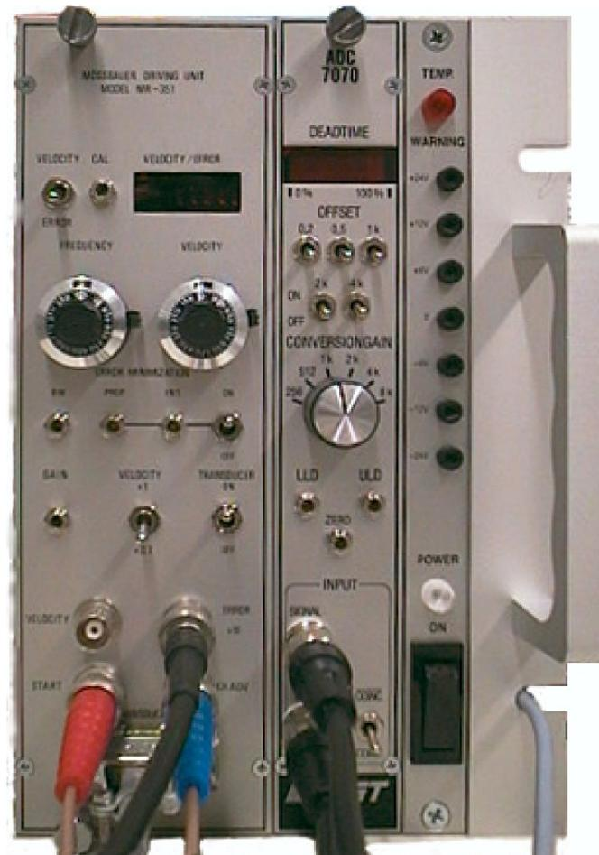
Abbildung 7: Bedienfronten von MR-351 (links), AD-Wandler (mitte) und Spannungsversorgung (rechts).
