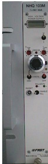
Abbildung 8: Spannungsversorgung des Zählrohres
