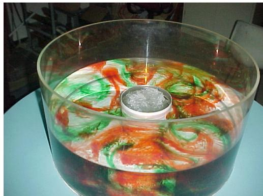
**Abbildung 17:** Beobachtete Verwirbelungen im rotierenden Bezugssystem bei aufprägtem Temperaturgradienten. [1]
