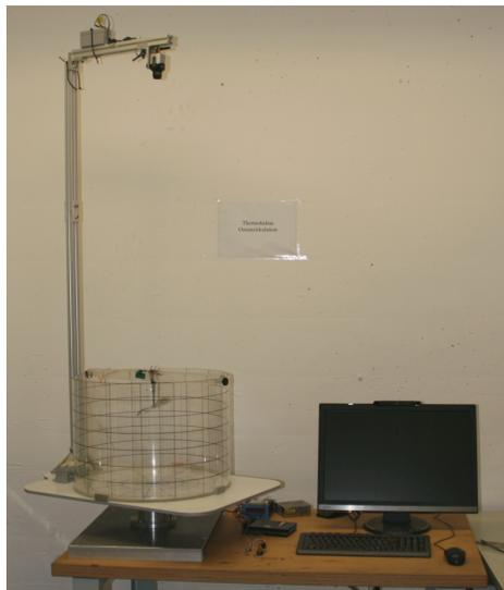
**Abbildung 1:** Foto der bestehenden Experimentieranlage. PID-geschwindigkeitsgesteuerter Drehtisch, welcher im Bezugssystem von oben mit einer mitrotierenden Kamera beobachtet werden kann. Die Videos werden via Funk an den Rechner übermittelt.
