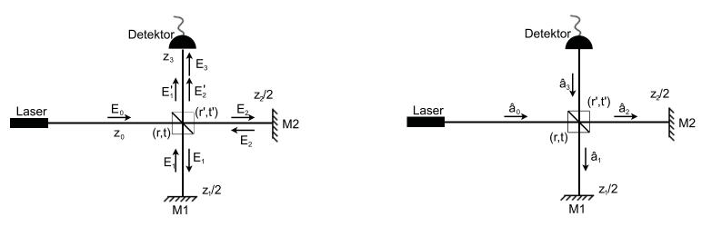
**Abbildung 5:** Schematische Darstellung eines Michelson-Interferometers. links: klassisch, rechts: quantenmechanisch
