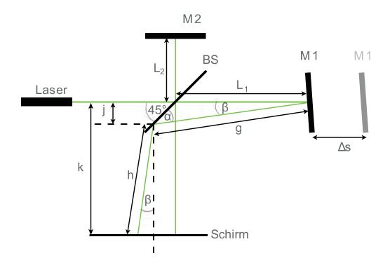
**Abbildung 7:** Schema eines Michelson - Interferometer mit gekipptem Spiegel. Der Laserstrahl trifft unter einem Winkel von  $45^{\circ}$  auf den Strahlteiler. Es besteht die Möglichkeit (M1) um  $\Delta s$  zu verschieben.
