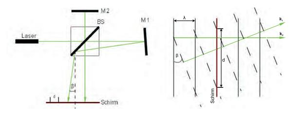
**Abbildung 6:** Links: Schematische Darstellung eines Michelson-Interferometers mit gekipptem Spiegel M1. Rechts: Zueinander verkippte Wellenfronten treffen auf einen Schirm und überlagern sich zu einem streifenförmigen Interferenzbild.
