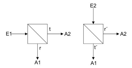
**Abbildung 2:** Schematische Darstellung eines Strahlteilerwürfels mit Eingängen (E1,E2) und Ausgängen (A1,A2).
