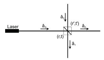
**Abbildung 4:** Schematische Darstellung eines Strahlteilerwürfels mit den Photonoperatoren  $\hat{a}_i$ ,  $i \in \{0, 1, 2, 3\}$ .
