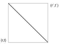
**Abbildung 1:** Schematische Darstellung eines Strahlteilerwürfels mit Reflexions- und Transmissionskoeffizienten (r,t) und (r',t').
