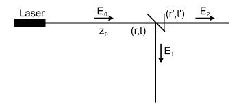
**Abbildung 3:** Schematische Darstellung eines Strahlteilerwürfels mit den klassischen Ein- und Austrittsfeldern  $E_0(z_0, t)$ ,  $E_1(z_0, t)$  und  $E_2(z_0, t)$ .
